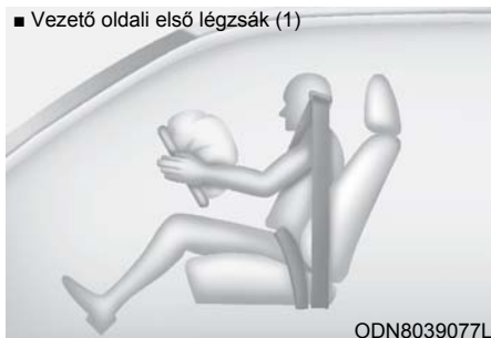
■ Vezető oldali első légszák (1)
