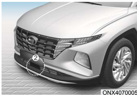
[1]: Előrefelé néző kamera [2]: Első radar
