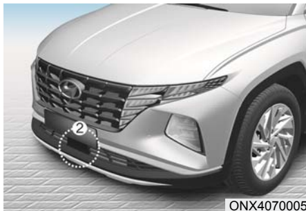
[1]: Előrefelé néző kamera [2]: Első radar
