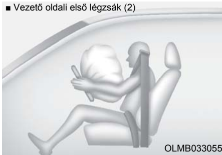
■ Vezető oldali első légszák (2)
