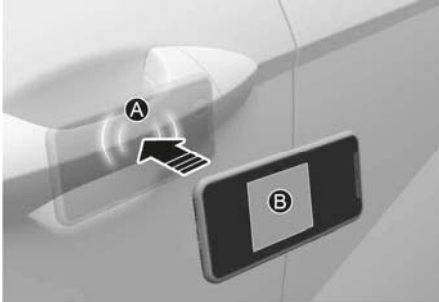
[A] Ajtókilincs hitelesítő felület [B] NFC-antenna
