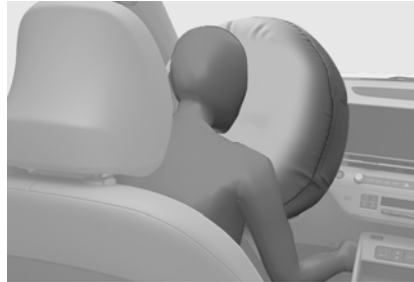
Vezető oldali első légszák (2)
