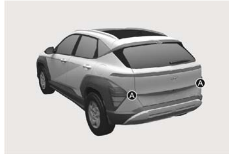
[A] Hátsó sarokban lévő radar
