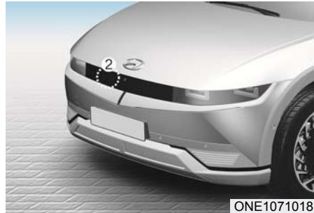
[1]: Előrefelé néző kamera, [2]: Első radar
