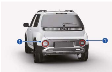
(1) Hátsó sarokban lévő radar
