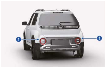
(1) Hátsó sarokban lévő radar
