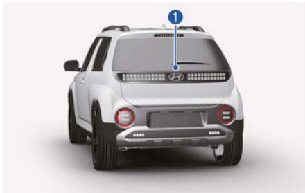
(1) Széles látószögű tolatókamera
