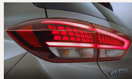
LED-es hátsó lámpatest
